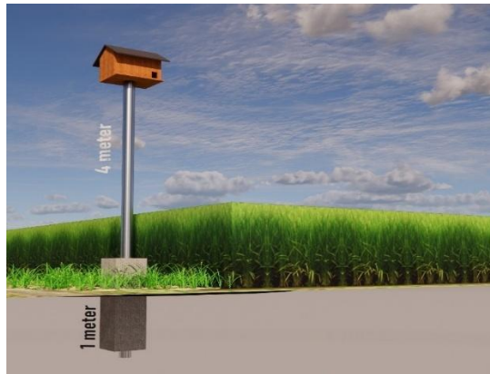
Gambar 3. Ilustrasi pemasangan rubuha di sawah
