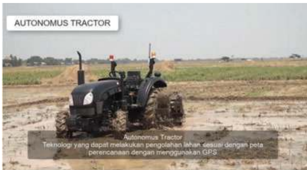
Gambar 4.8. Autonomus Tractor, Pengolahan Lahan Menggunakan GPS
