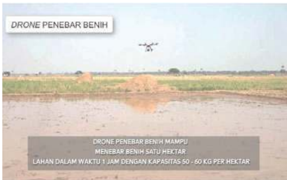
Gambar 4. 9. Drone Penebar Benih dengan Kapasitas 50-60 kg/ha
